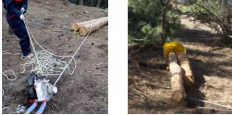
Şekil 4. Benzinli el vinci ile sürütme
