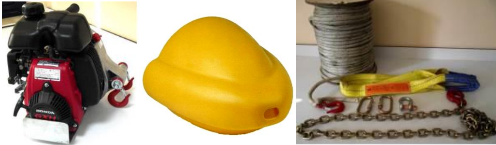
Şekil 2. Benzinli el vinci (sol), sürütme konisi (orta), sentetik halat, çokerler ve metal kilit (sağ)
