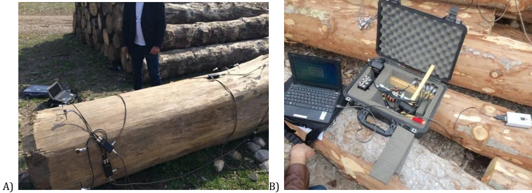
Şekil 3. Çalışmada kullanılan hasarsız test (Fakkop 3D Akustik Tomografi) cihazı.
