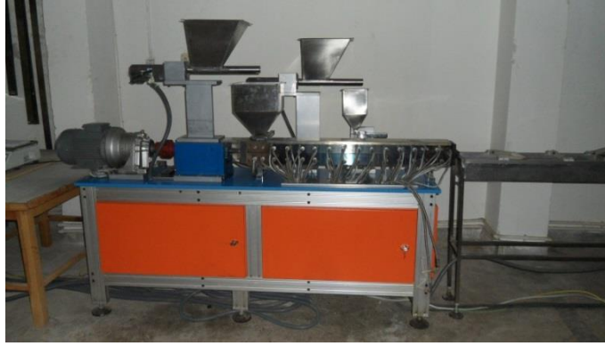
Şekil 1. Çift vidalı ekstruder
